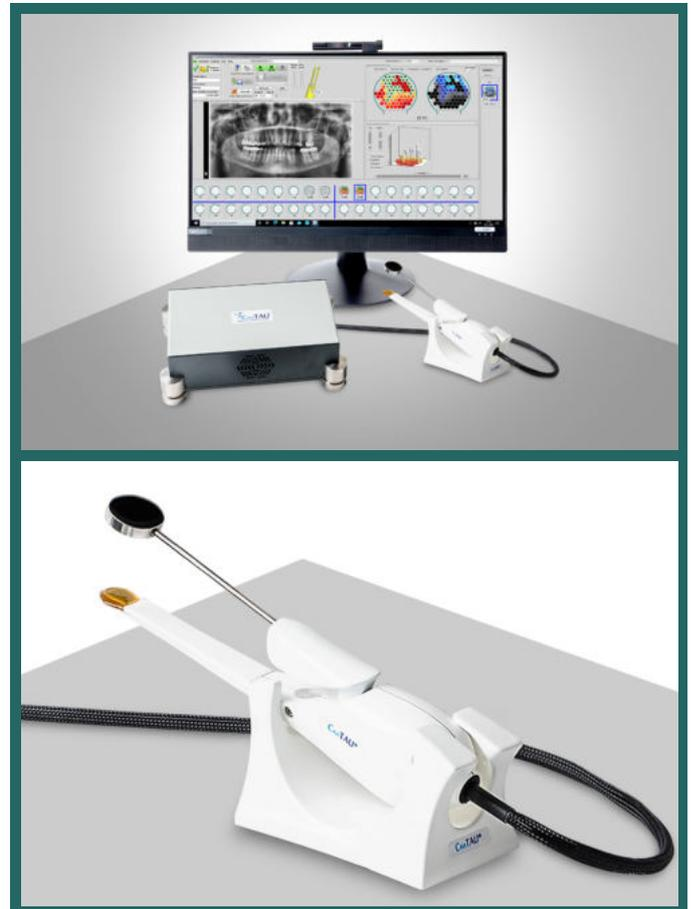
Abb 1: Links: Zentrale Rechneinheit von CaviTAU (Mitte) mit Ultraschall-Handstück (unten) und Bildschirmanzeige. Rechts: Vergrößerte Abbildung des Handstücks mit Ultraschall-Sender (schwarz) und Ultraschall-Empfänger (in Gold)
